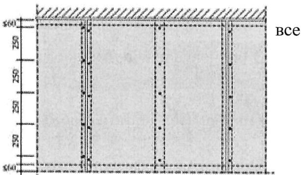
6. ГСП устанавливается на пол без зазора, для большей устойчивости конструкции.
